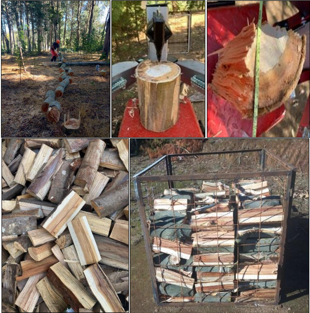
Figura 4. Proceso de producción de leña para estudio de estimación de número de astillas por árbol
