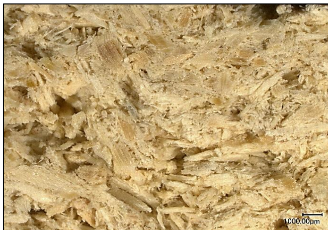
Figura 1. Aspecto macroscópico del compuesto lignocelulósico a base de aserrín de P. pseudostrobus aglutinado con adhesivo natural de proteína de trigo.
