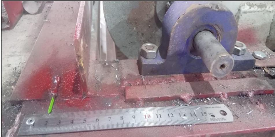
**Figura 24.** Sistema de medición del movimiento horizontal del rodillo libre de la rompedora de semillas.
