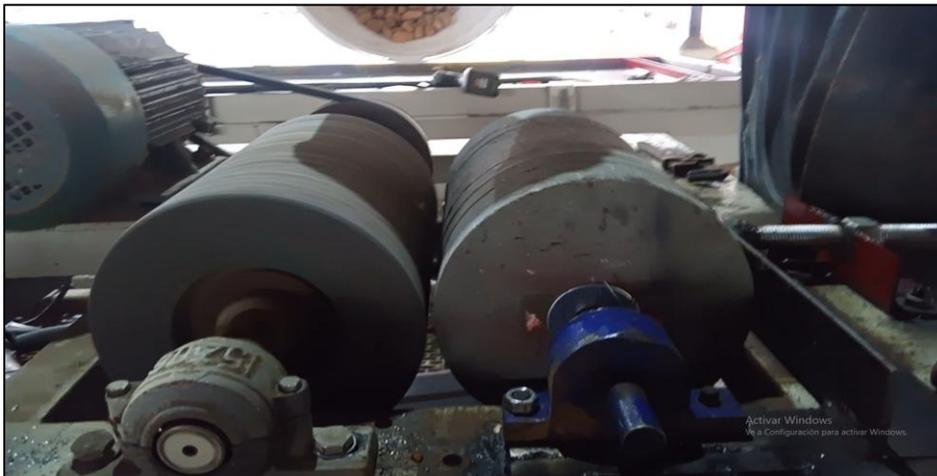
Figura 21. Rodillos del nuevo sistema rompedor de semillas
