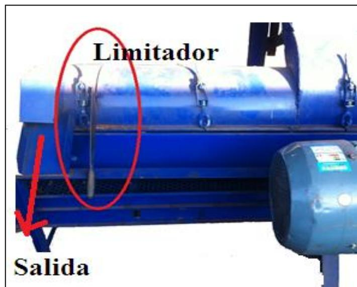
Figura 4. Limitador del sistema rompedor de piñas.
