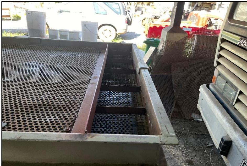
**Figura 14.** Detalles de la modificación del primer harnero, para tener acceso directo al harnero inferior para repaso de las semillas.
