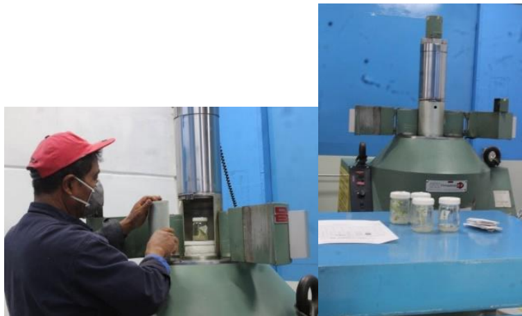
Figura 3. Práctica de irradiación en equipos Gamacell 220, para pruebas de radiosensibilidad en plantas de cultivo in vitro y semillas.
