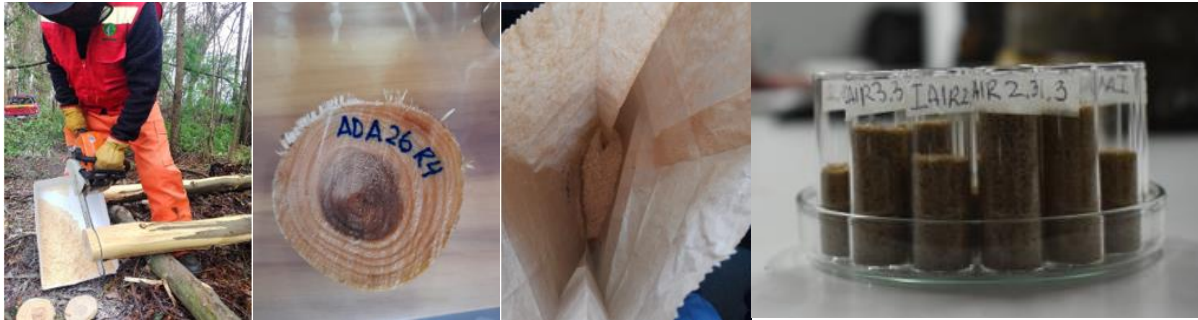
Figura 3. Extracción de muestras de rodela y viruta
