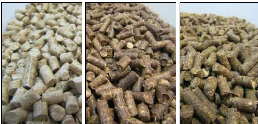
Figura 5. Pellets de fuste (izq.), de ramas (centro) y de acículas (der.) utilizados en los ensayos.
