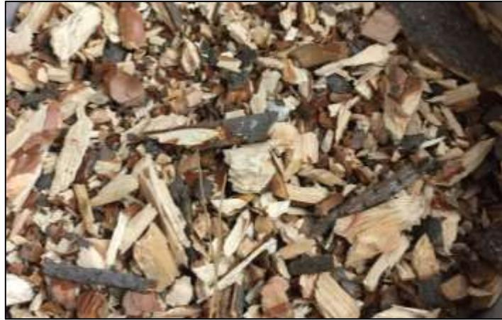
**Figura 6.** Astillas de ramas de pino ponderosa sin follaje utilizadas en los ensayos.
