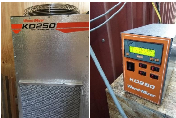
Figura N° 9 EQUIPO KD250 WOODMIZER PARA TERMINAR EL PROCESO DE SECADO
