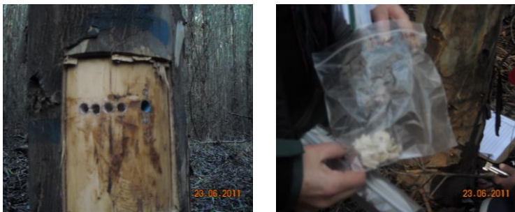
Figura N° 5 COLECTA DE VIRUTA DE ÁRBOLES CANDIDATOS PARA ANÁLISIS DE CONTENIDO DE LIGNINA A TRAVÉS DE SISTEMA NIR
