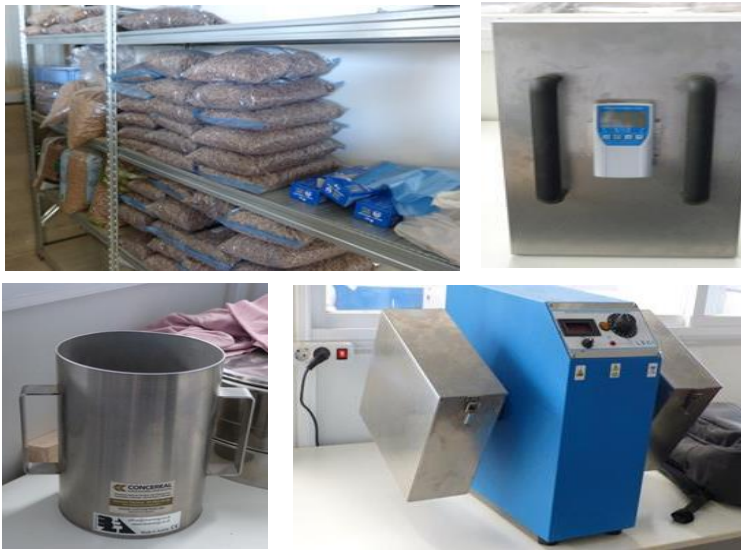
Figura N° 6 ALMACENAMIENTO MUESTRAS (SUP IZQ), MEDIDOR DE HUMEDAD POR CONDUCTIVIDAD (SUP DER), PROBETA VOLUMÉTRICA (INF IZQ) Y ANALIZADOR RESISTENCIA MECÁNICA (INF DER)
