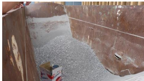
Figura N° 2 DAÑOS FALLAS EN TORNILLOS SIN FIN DE ALIMENTACIÓN DE ASTILLAS A LA CALDERA (IZQ) Y ACUMULACIÓN DE PIEDRAS EN DEPÓSITO DE CENIZAS (DER)
