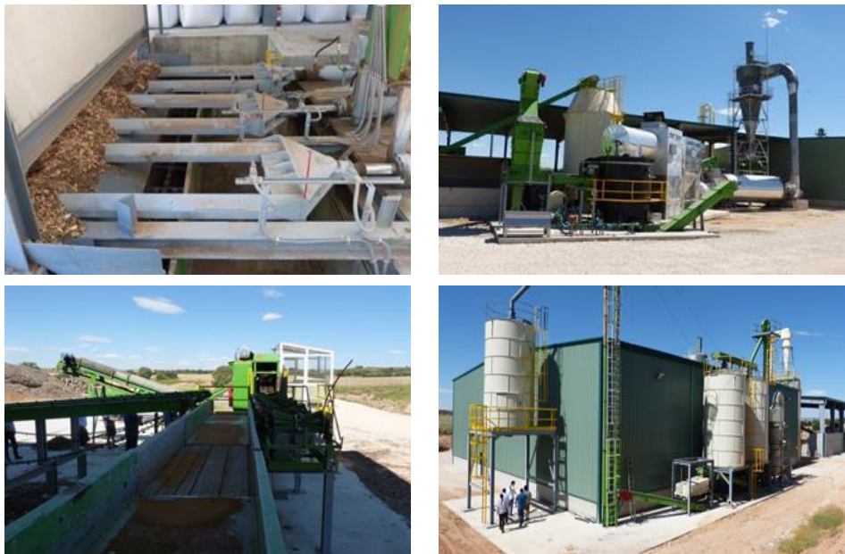
Figura N° 7 ASTILLAS DE RESIDUOS EN PISO MÓVIL (SUP IZQ), PRODUCCIÓN DE MICROASTILLAS Y SECADO PARA PELLET (SUP DER), ALIMENTACIÓN DE MATERIA PRIMA (INF IZQ) Y XILOS DE ALMACENAMIENTO DE PRODUCCIÓN (INF DER)
