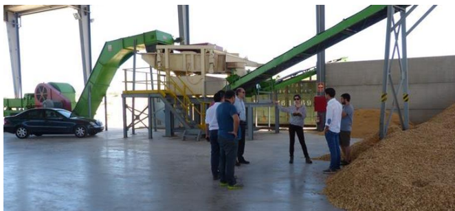
Figura N° 5 PROCESO PRODUCCIÓN, ASTILLADO (IZQ), CRIBADO (CENTR), ASTILLA INDUSTRIAL (DER)
