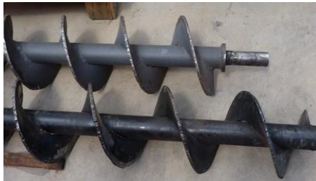
Figura N° 2 DAÑOS FALLAS EN TORNILLOS SIN FIN DE ALIMENTACIÓN DE ASTILLAS A LA CALDERA (IZQ) Y ACUMULACIÓN DE PIEDRAS EN DEPÓSITO DE CENIZAS (DER)
