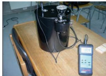
Equipo y lectura temperatura durante combustión
