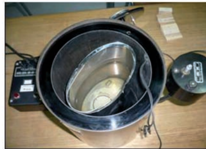
Equipo calorimétrico (aire, agua, estanco)
