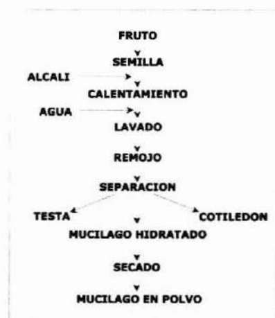
Figura N° 9 ESQUEMA GENERAL DEL PROCESAMIENTO INDUSTRIAL DE VAINAS DE ALGARROBO PARA OBTENCIÓN DE MUCÍLAGO
