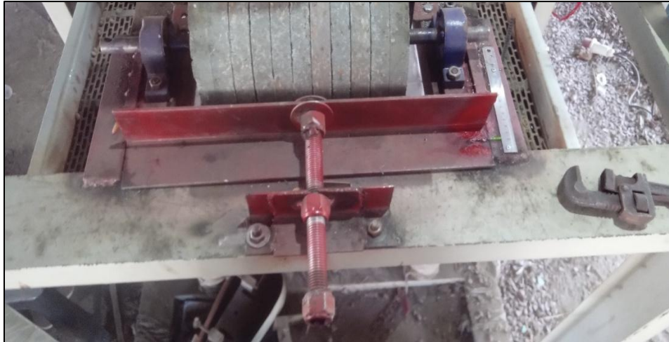
Figura 23. Sistema unitario de regulación de distancia entre rodillos de la rompedora de semillas, con un solo tornillo
