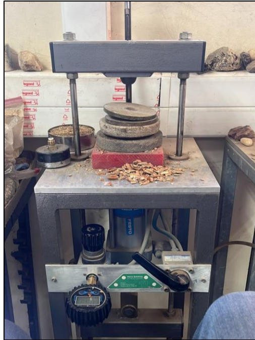
Figura 1. Máquina neumática de determinación de firmeza de cascara (Universidad de Kiel, Kiel, Alemania, fabricación propia)
