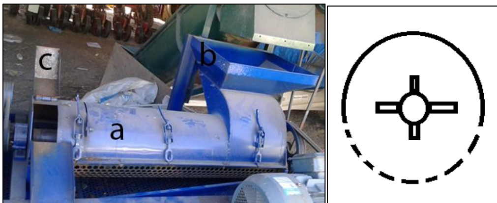
Figura 2. Detalle de la partidora de piñas. a) Tambor rompedor; b) tolva de alimentación; c) Sistema de expulsión de raquis. A la derecha, esquema trasversal de las garras del molino.
