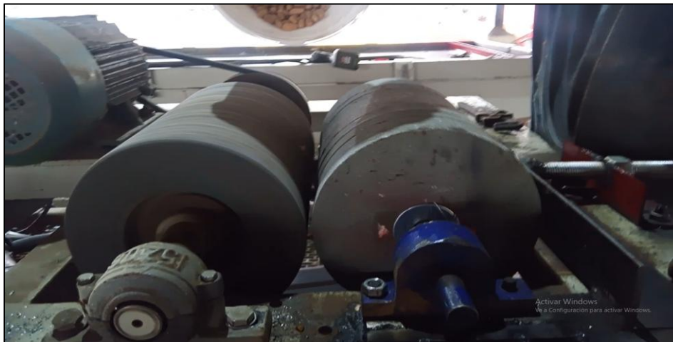
Figura 21. Rodillos del nuevo sistema rompedor de semillas
