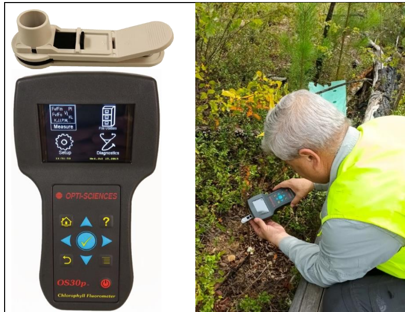
Figura 3. Fluorómetro y pinza para oscurecimiento de hojas (izquierda); medición de plantas en terreno (derecha).
